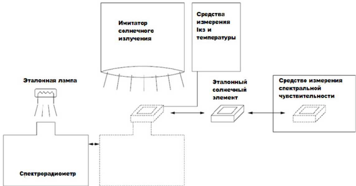
Рисунок 1 - Схема реализации метода калибровки фотоприемников с использованием ИСИ класса ААА
