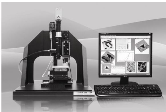
Рисунок 1 - Сканирующий зондовый микроскоп «НаноСкан-3Д»
