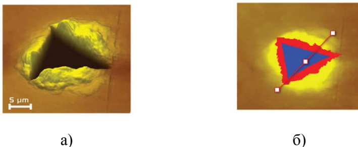
Рисунок 9 - Результат работы алгоритма. Материал: сталь У10. а) СЗМ-изображение восстановленного отпечатка; б) расчет контактной площади восстановленного отпечатка и площади навалов по его периметру
