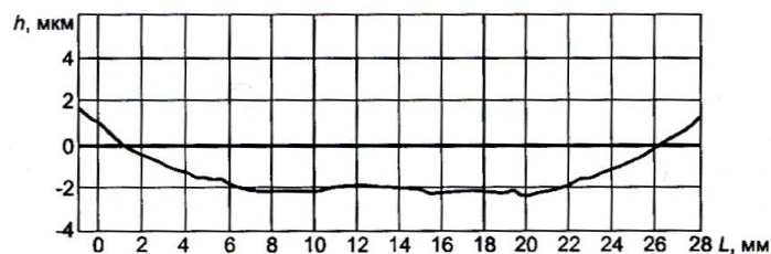
Рис. 6 а – Профилограмма основания после нанесения подслоя никеля.
